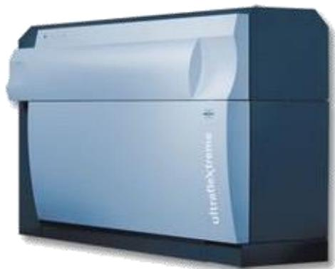
基质辅助激光解析电离-飞行时间质谱仪
